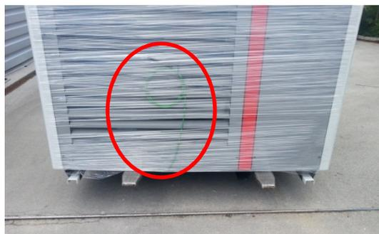
При установке вилок погрузчика под устройство следует соблюдать осторожность, чтобы не повредить греющий кабель (зеленый цвет), предназначенный для предотвращения замерзания в дренажной трубе конденсата
