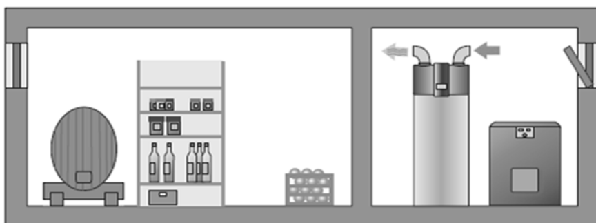
Рисунок 2: Поступление воздуха из той же комнаты и отведение его обратно.
